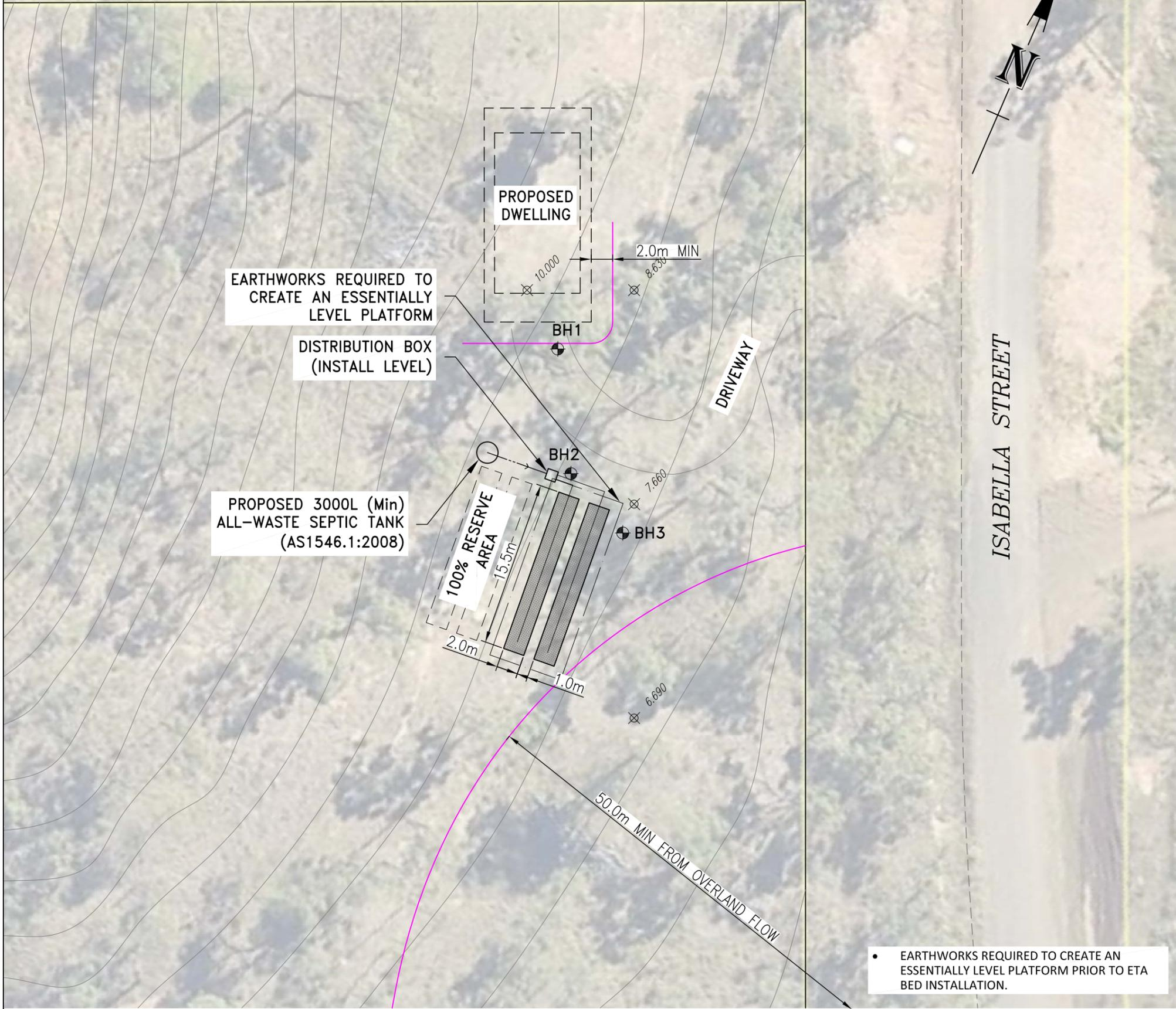
• EARTHWORKS REQUIRED TO CREATE AN ESSENTIALLY LEVEL PLATFORM PRIOR TO ETA BED INSTALLATION.
